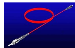
FOXT 延長ケーブル (最長100m以上) -40 ~ 85℃ φ3.0mm PVC
